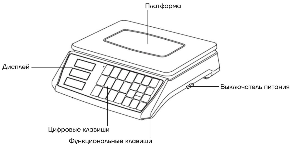
Рисунок 1. Весы торговые электронные без стойки (вид спереди/справа)
